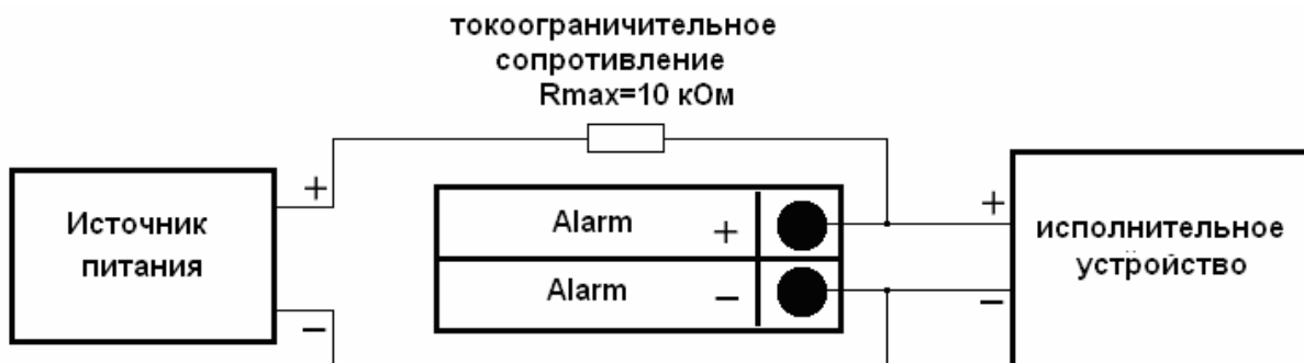
Рис. 3-11. Используйте внешний источник питания, если необходимо напряжение питания отличное от питания расходомера.
